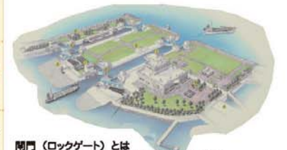
閘門(ロックゲート)とは ①高低差の大きい水面で船舶を昇降させる装置 ②瀬河、放水溜などで水量を一定にするための堰(セキ)
